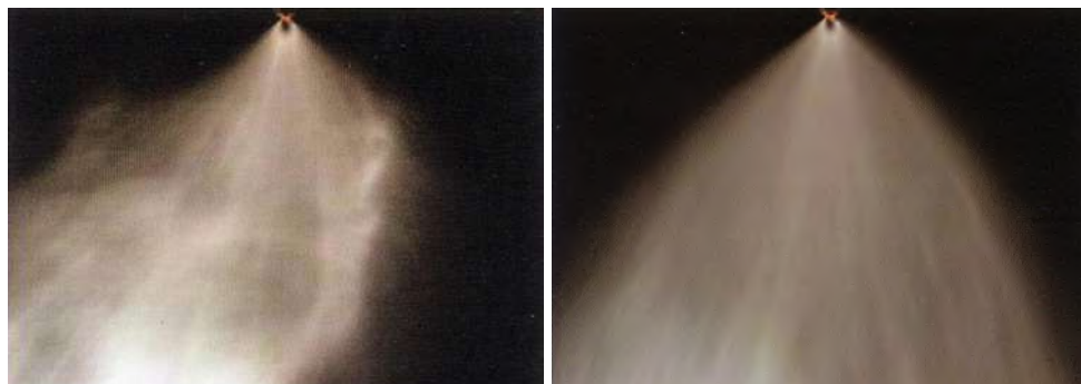
Permetcsepp 7,5 km/h szélben, Heliosol nélkül (balra) és Heliosollal (jobbra)
